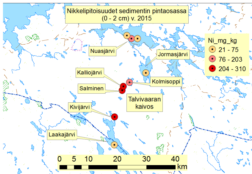
Kuva 15. Nikkelipitoisuudet sedimentin pintaosassa (0–2 cm) v. 2015. Näytteet kerätty Talvivaaran kaivoksen velvoitetarkkailutuloksista (Terrafame Oy, 2016). Tulosten mukaan suurimpia pitoisuuksia esiintyy pienissä ja kaivoksen läheisyydessä olevissa järvissä. Etäisyyden kasvaessa pitoisuudet pienenevät kohti alavirtaa.
